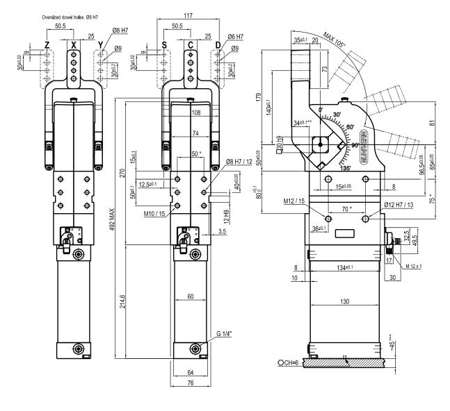
\* : TOLERANCE BETWEEN DOWELS  $\pm$  0,02, BETWEEN SCREW HOLES  $\pm$  0,1 \*\* : TOLERANCE AT 80 mm FROM PIVOT POINT
