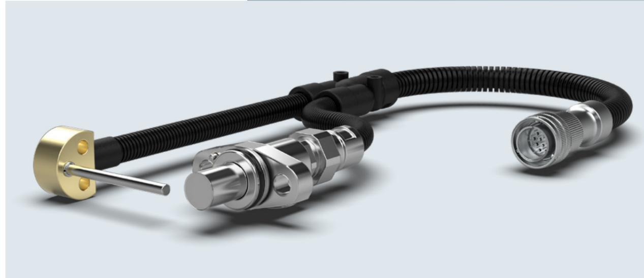
Ist der Einbauraum am Fahrwerk begrenzt, führen wir in unserem CombiCODER mehrere Sensortypen in einem Gehäuse zusammen. Sie messen z. B. gleichzeitig Drehzahl, Temperatur und Schwingungen. Alternativ kombinieren wir verschiedene Sensoren individuell nach Ihren Vorgaben und passen bei Bedarf die Bauform an. Ihr Vorteil: Statt drei bis vier Sensoren müssen Sie lediglich einen Sensor montieren und prüfen. Das reduziert den Aufwand für Montage und Instandhaltung deutlich.
